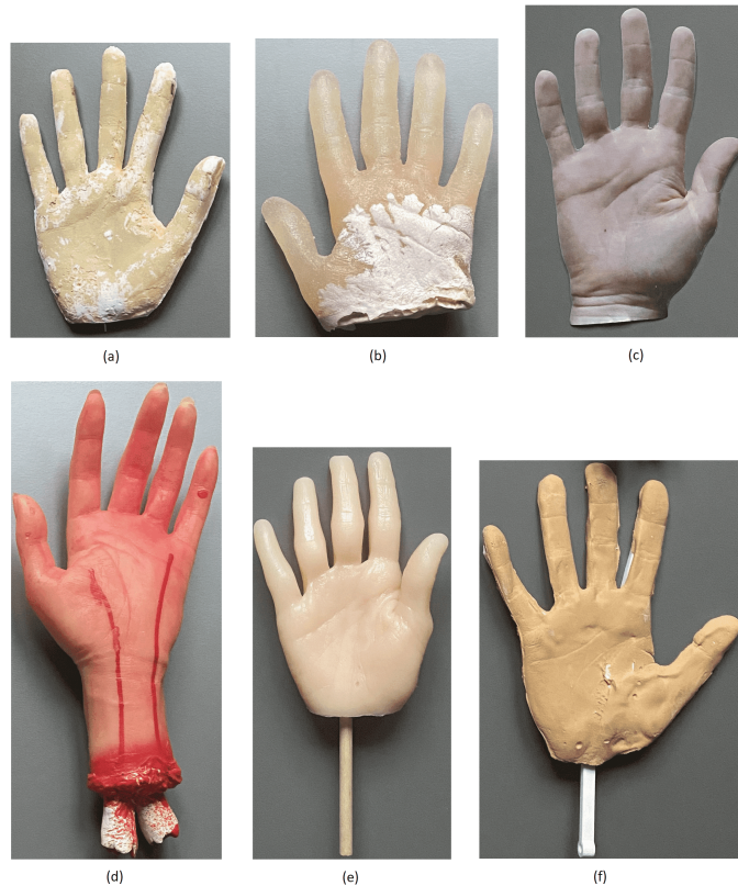
Obr. 3.1: Príklad falzifikátov použitých na snímanie prstov použitých pri prezentačnom útoku.
