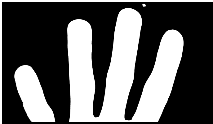
Obr. 4.3: Maska zo snímku ruky (získaná po binárnom prahovaní), kde sú spojené 3 prsty mostíkom, ktorý sa nachádza v dolejšej časti.
