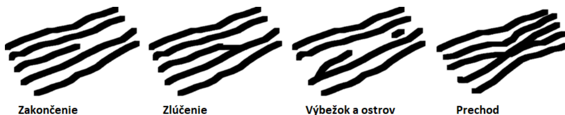
Obr. 2.7: Typy markantov (zakončenie, zlúčenie/rozdelenie (bifurkácia), výbežok a ostrovček, prechod). (Obrázok prevzatý z [4].)
