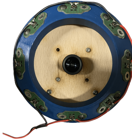
Obr. 4.2: Kamera použitá na snímanie falzifikátov použitých pri implementácii a testovaní metódy detekcie prezentačného útoku.
