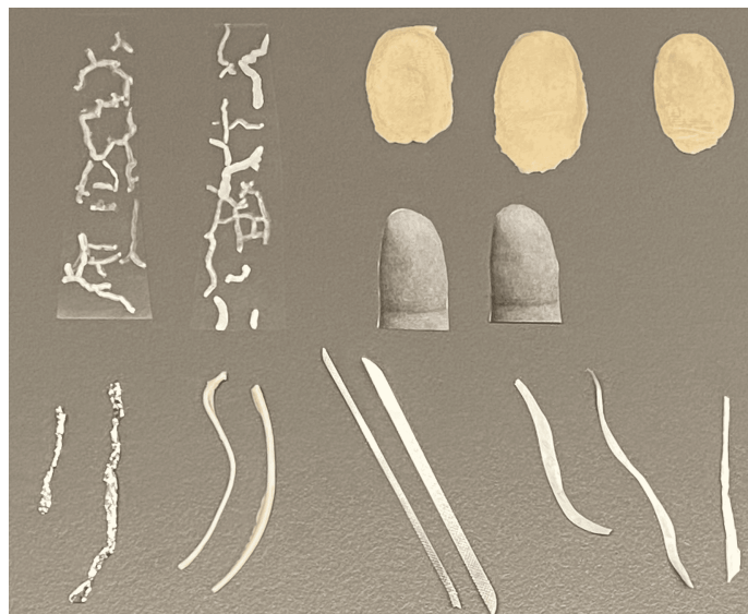
Obr. 3.2: Príklad materiálov použitých ako falzifikát žíl, ktoré boli použité pri snímaní dátovej sady predstavujúcej prezentačný útok. V poradí zľava doprava – strieborná fixka, silikónové prekrytie, výtláčok prekrytia špičky prsta, strieborná fólia (alobal), nitrilový ústrižok, strieborná fólia, biely papier.
