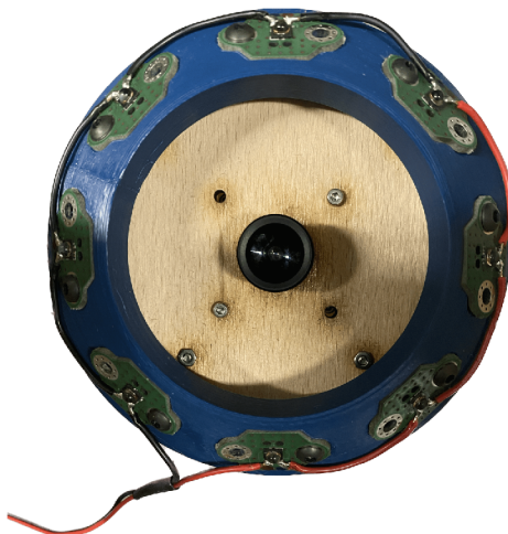
Obr. 4.2: Kamera použitá na snímanie falzifikátov použitých pri implementácií a testovaní metódy detekcie prezentačného útoku.
