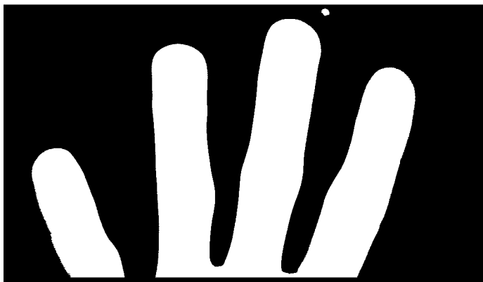
Obr. 4.3: Maska zo snímku ruky (získaná po binárnom prahovaní), kde sú spojené 3 prsty mostíkom, ktorý sa nachádza v dolejš časti.
