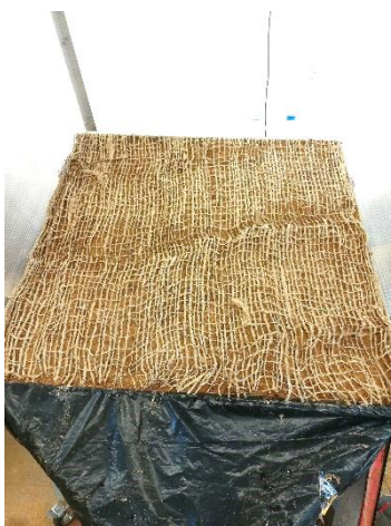
Obr. č. 31 – Žlab J500 před zátěžovým deštěm
