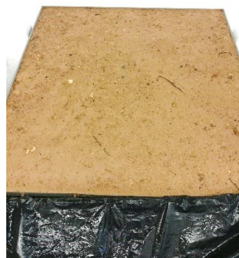
Obr. č. 30 – Žlab kontroly po zátěžovém dešti
