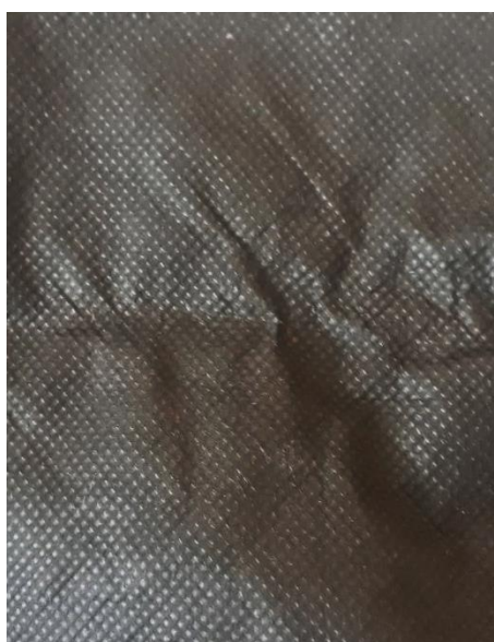
Obr. č. 8 – Filtrační geotextilie
