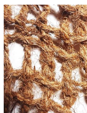
Obr. č. 3 – Kokosová protierozní síť 700 \text{ g/m}^2 (C700)
