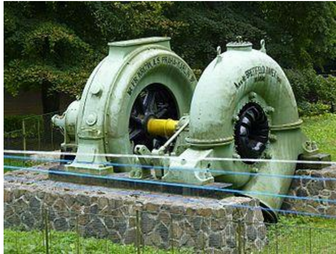
Obrázek 29 - Původní Francisova turbína
