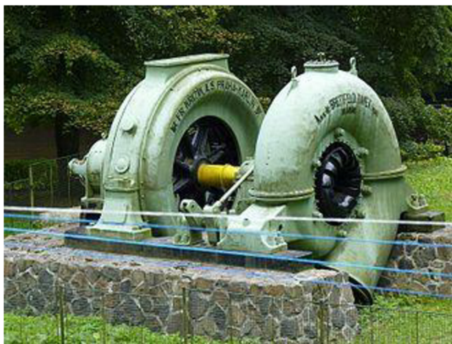
Obrázek 29 - Původní Francisova turbína
