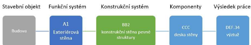
Obrázek č. 21 Příklad identifikace stěny klasifikačním systémem CoClass [38]
