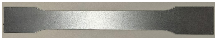
Obr. 3.2 Ukázka zkušebního tělesa pro statickou zkoušku tahem
