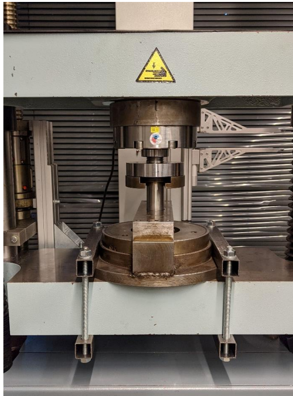
Obr. 3.5 Zařízení pro měření střížné síly TIRAtest 2300
