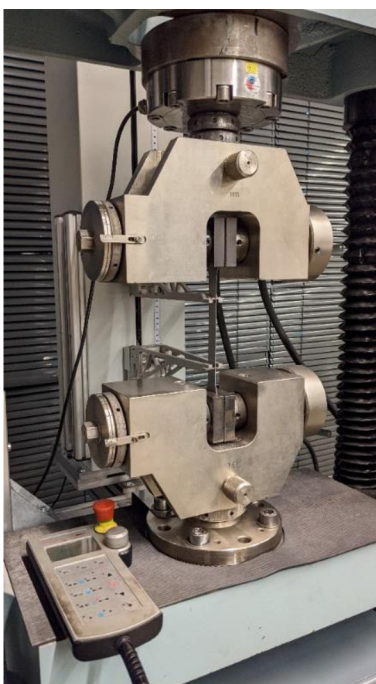
Obr. 3.3 Trhací zařízení TIRAtest 2300
