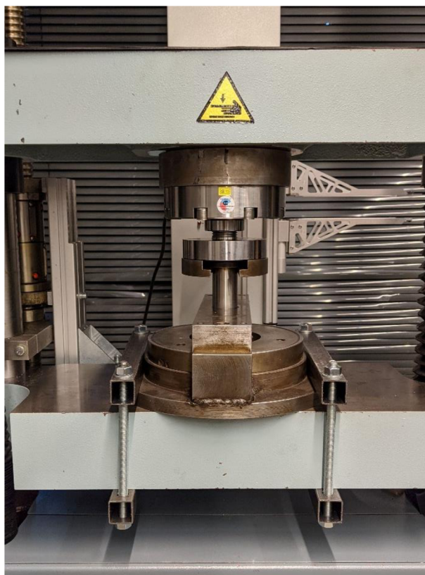
Obr. 3.5 Zařízení pro měření střížné síly TIRAtest 2300
