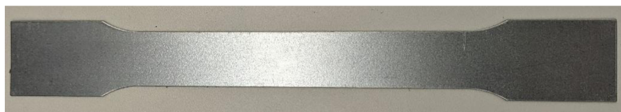
Obr. 3.2 Ukázka zkušebního tělesa pro statickou zkoušku tahem
