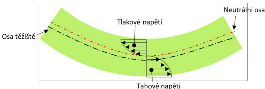
Obr. 2.16 Rozložení napětí při ohýbání
