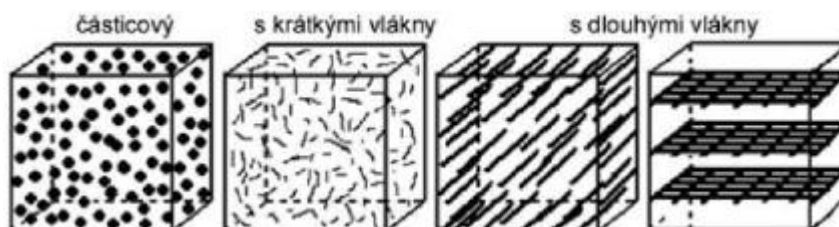
Obrázek 1.5.3 Dělení kompozitů dle druhu a uspořádání výztuže [27]
