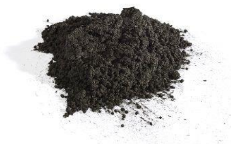
Obrázek 2.1.1 Recyklovaná mletá uhlíková vlákna Carbiso Mil 100 \mu\text{m} [47]
