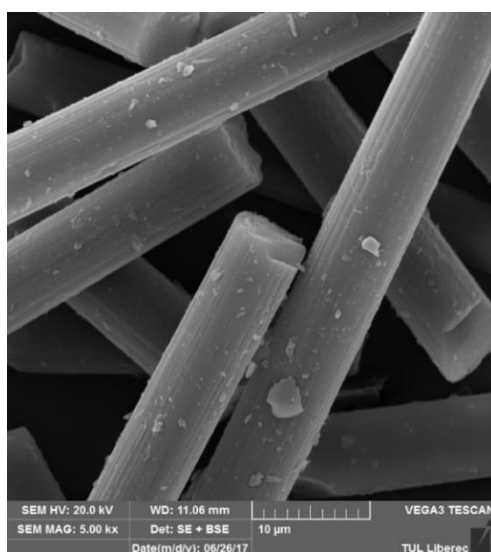
Obrázek 2.1.6 Uhlíková vlákna Carbiso 5000 \times zvětšeno
