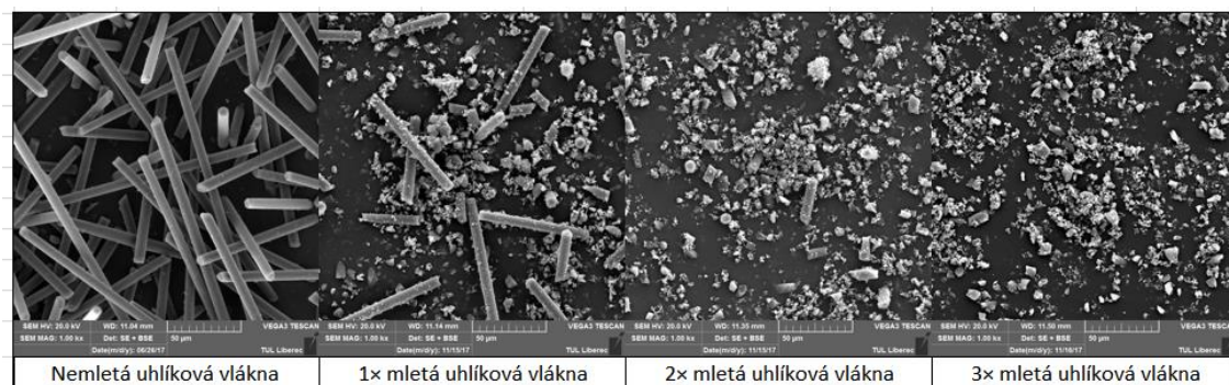
Obrázek 2.1.13 Přehled postupně mletého materiálu 1000× zvětšeno 1
