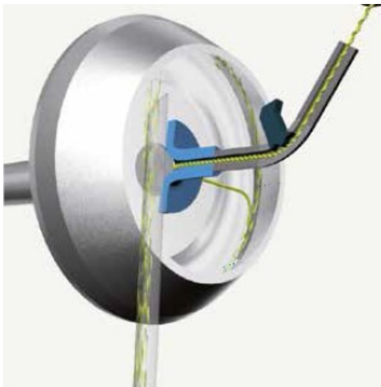
Obr. 4.3 Princip zákrutu v rotoru [9]
