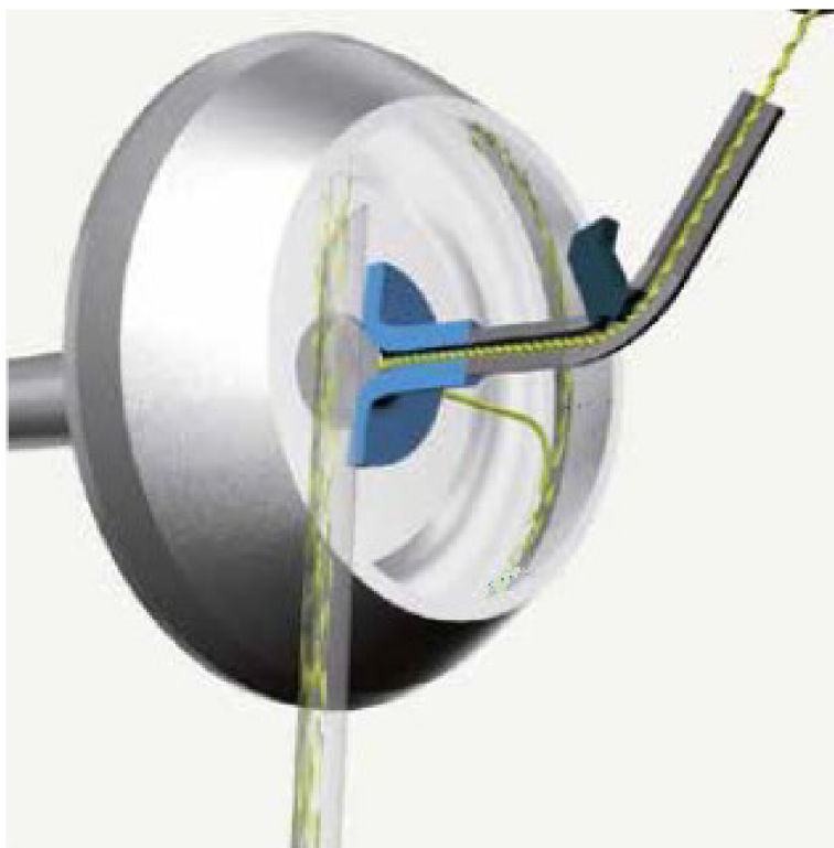
Obr. 4.3 Princip zákrutu v rotoru [9]
