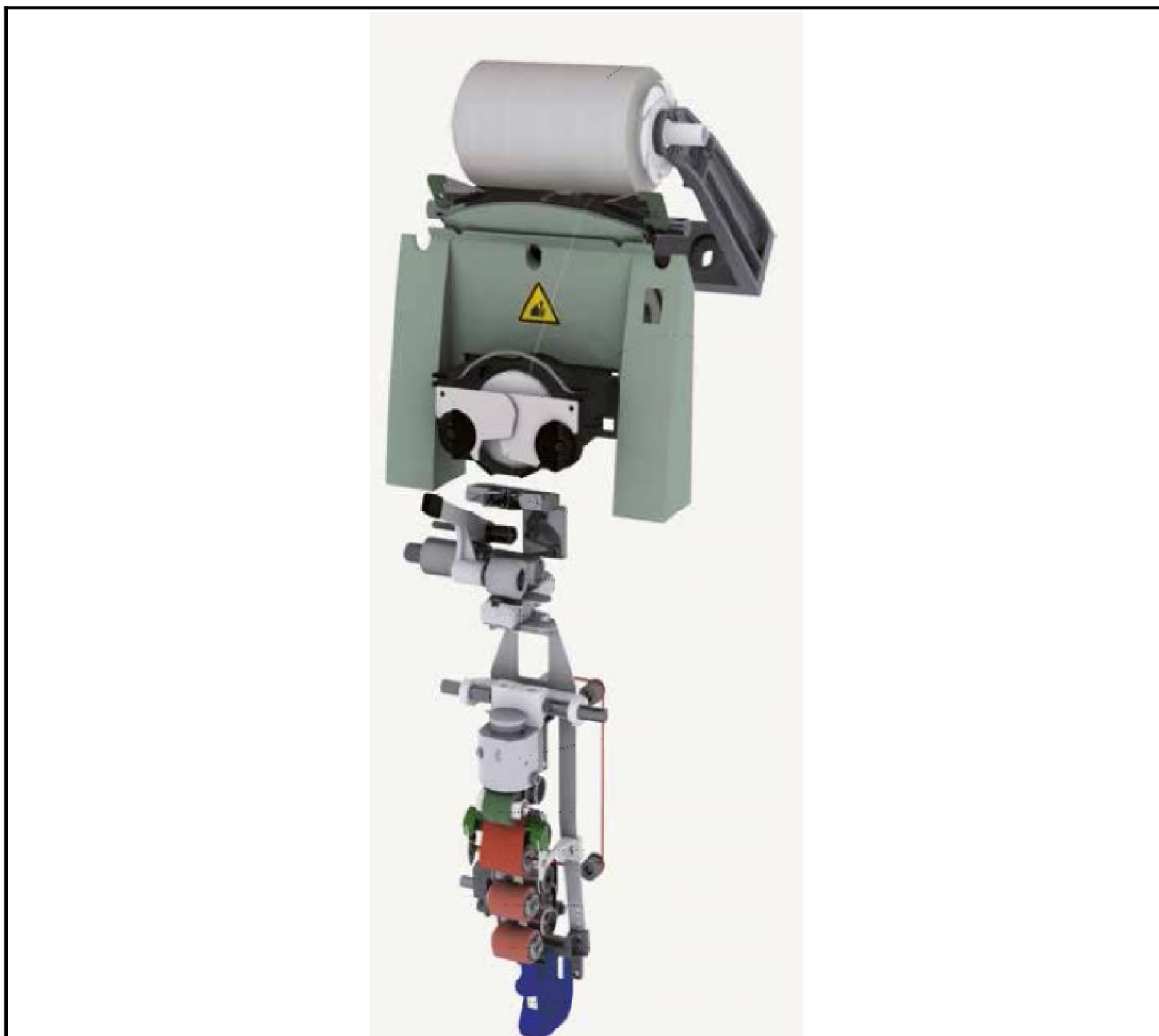
Obr. 4.7 Spřádní a navíjecí jednotky stroje Air-jet [10]
