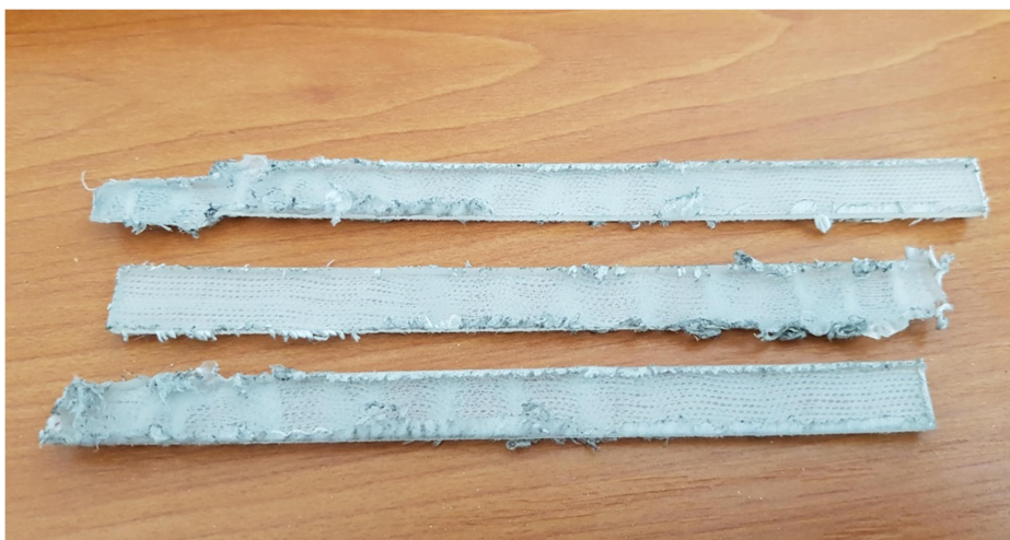
Obr. 3.4 Popraskaná tělesa po řezání vodním paprskem
