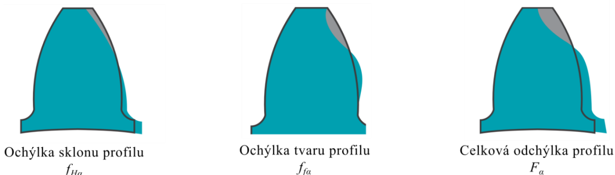
Obr. 28 Odchýlky od teoretického tvaru profilu zubov. [45]
