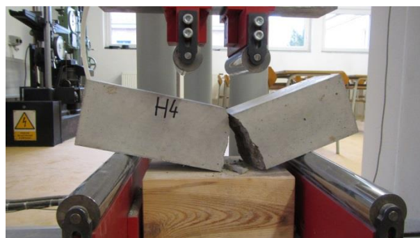
Obr. P5-12: Hranol H4 porušený ohybem
