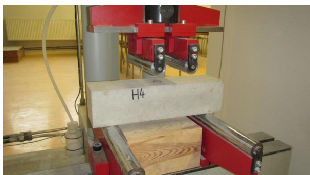
Obr. P5-11: Stanovení pevnosti v tahu ohybem (4-bodový ohyb)
