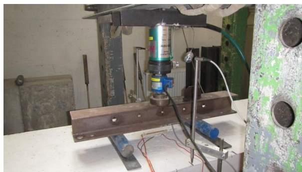
Obr. P5-19: Hydraulický lis a ocelové roznášecí prvky pro zajištění 4-bodového ohybu
