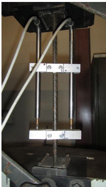
Obr. P5-13: Připravená zkouška tahové pevnosti oceli (výztuž \phi 10\text{mm} )
