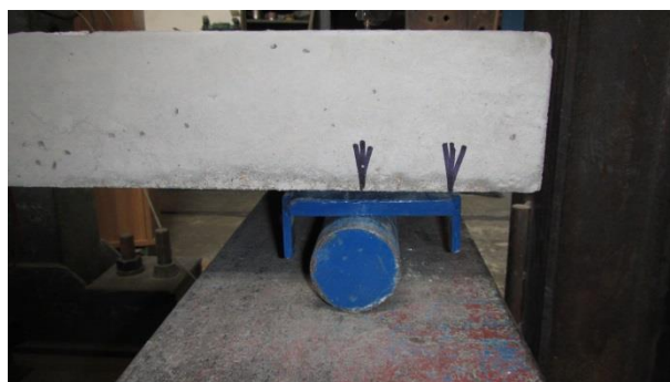
Obr. P5-21: Detail posuvné podpory
