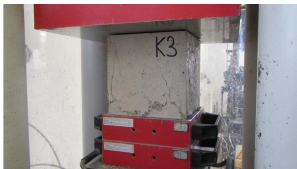
Obr. P5-8: Porušení zkušebního tělesa K3 tlakem
