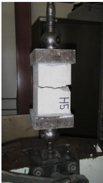
Obr. P5-16: Porušení vzorku H5 při zkoušce prostým tahem
