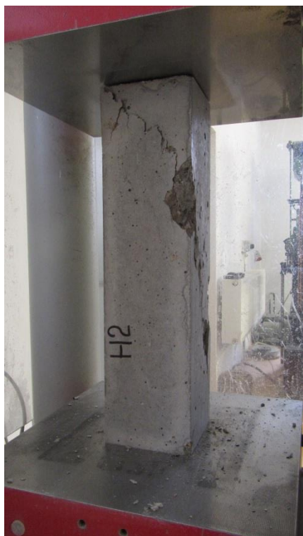
Obr. P5-9: Porušení hranolu H2 tlakem
