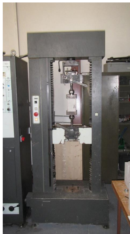
Obr. P5-17: Zkušební lis se vzorkem pro zkoušku prostým tahem
