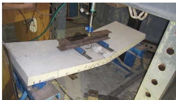
Obr. P5-31: Vznik plastického kloubu v betonu: ukončení zatěžovací zkoušky
