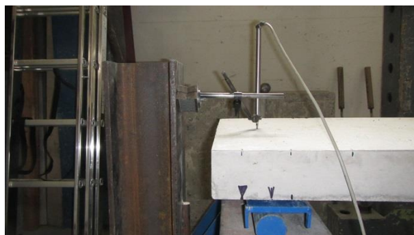
Obr. P5-23: Potenciometrický snímač dráhy pro měření poklesu podpory
