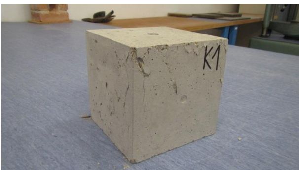
Obr. P5-7: Porušení zkušebního tělesa K1 tlakem
