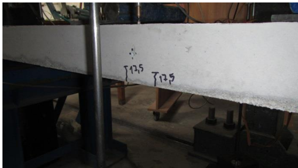
Obr. P5-26: Vznik trhlin při dosažení 17,5 kN
