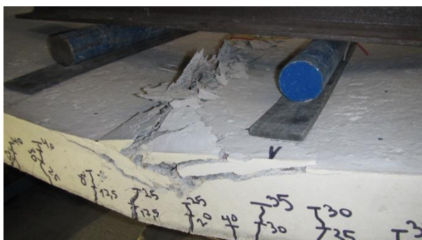
Obr. P5-30: Tlakové porušení betonu II
