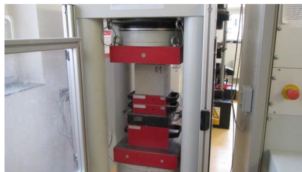
Obr. P5-6: Zkušba pevnosti betonu v tlaku – usazení tělesa v lisu
