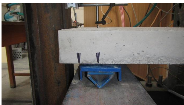
Obr. P5-20: Detail pevné podpory
