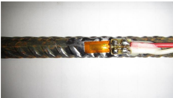
Obr. P5-1: Lepený foliový odporový tenzometr na výztuž
