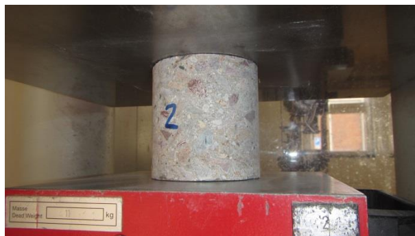
Obr. P5-33: Zkouška pevnosti v tlaku jádrových vývrtů
