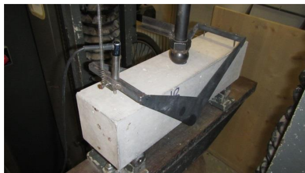
Obr. P5-15: Stanovení lomové energie betonu (3-bodový ohyb)
