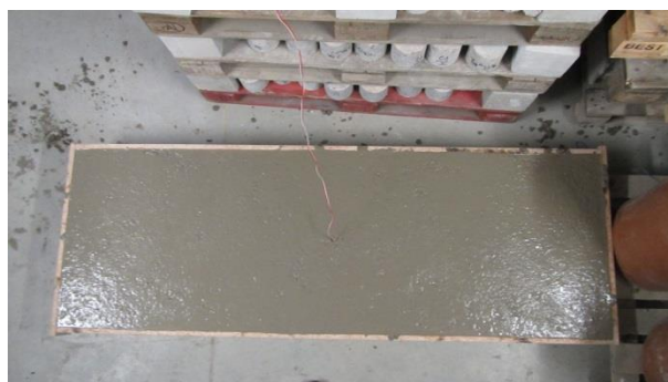
Obr. P5-4: Vybetonovaná a uhlazená zkušební deska
