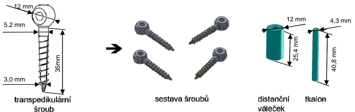
Obr. 12.1.4.1. - vytvoření modelu geometrie fixátoru v programu SolidWorks
