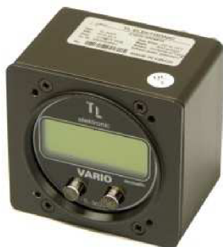
Obr. 5.7 – Variometr TL-3624 - měřicí rozsah +/-20 m/s - montážní průměr 60 mm
