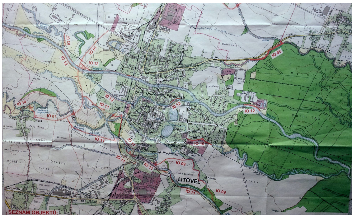
Obr. 6: Mapa připravovaných protipovodňových opatření v Litovli, zdroj: Grepl, P. Objekty: IO 01 hráz ochranná západní, IO 05 obnovení Třídvorky, IO 07 ochranná hráz podél Zámecké Moravy, IO 09 úprava Strusky, IO 10 Radniční Morava – obnovení koryta, IO 11 Mlýnský potok, IO 12 Morava, IO 13 Elektrárenský náhon, IO 14 Víška
