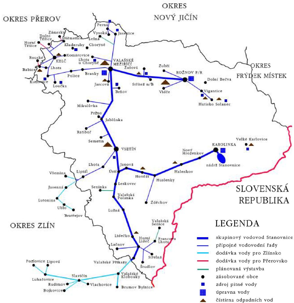
Obr. 22 Schéma zásobování vodou v okrese Vsetín, Zlín, Přerov [34]
