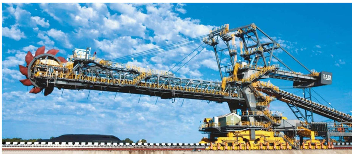
Obr. 35 Kombinovaný skládkový stroj FAM STR6000/8000.60 [34]
