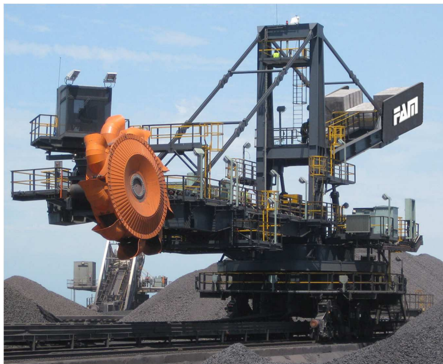
Obr. 32 Kolesový nakladač FAM RE2500.25 s letmo uloženým kolem [33]
