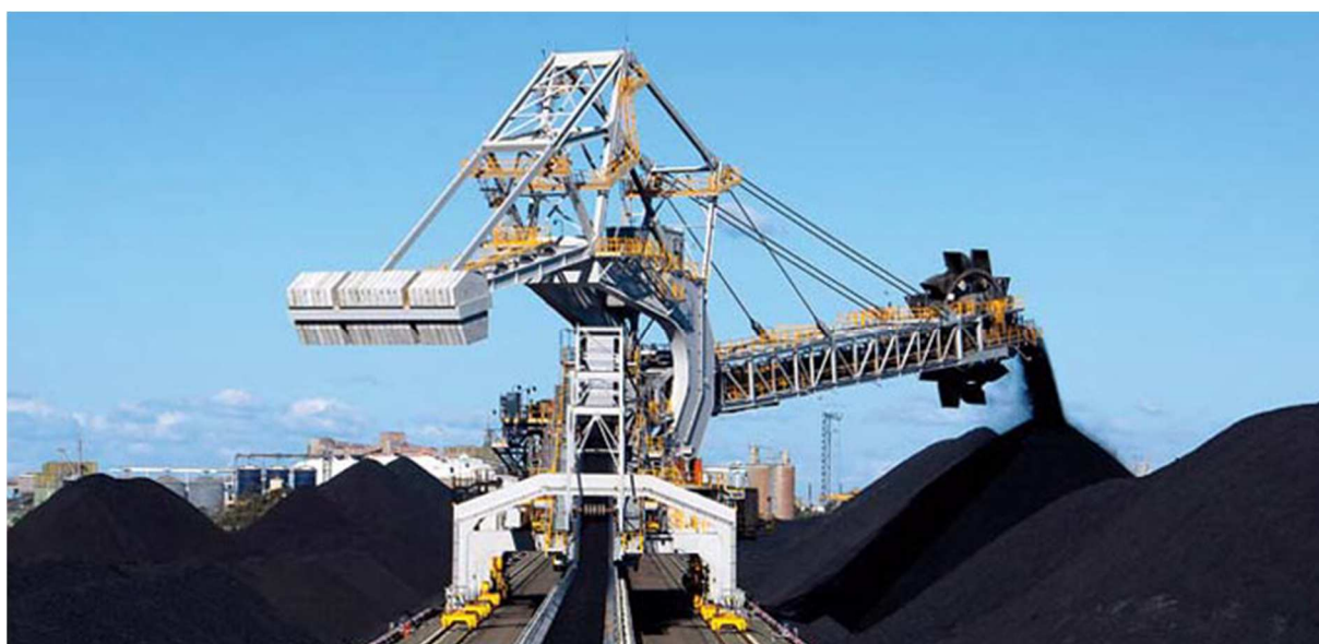
Obr. 5 Kombinovaný skládkový stroj při zakládání uhlí [35]
