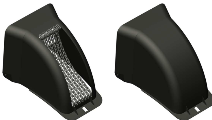
Obr. 8 Koreček s řetězovým dnem (pryžový pás není zobrazen) ve srovnání s celoplechovým
