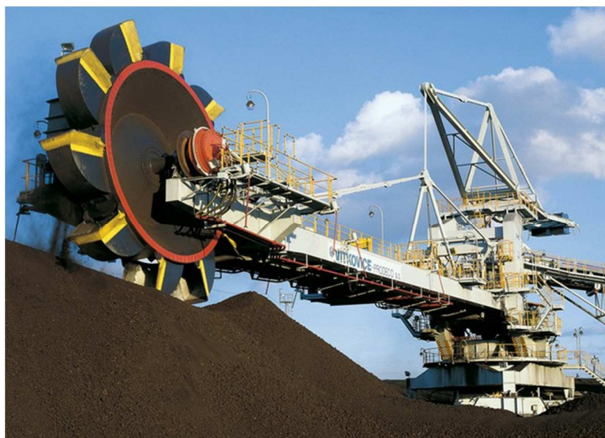
Obr. 31 Kombinovaný skládkový stroj Prodeco KSS 4000/3500 s kolesem uloženým mezi ložisky [36]
