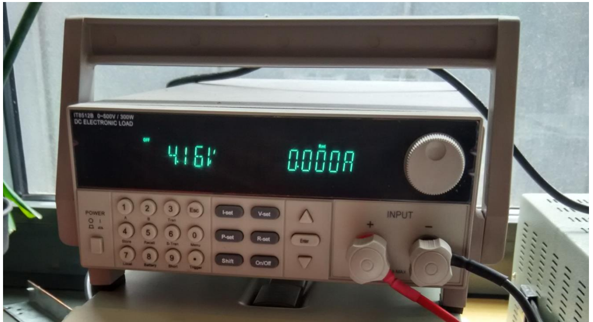
Obr. č. 6: Elektronická zátěž Itech IT8512B
