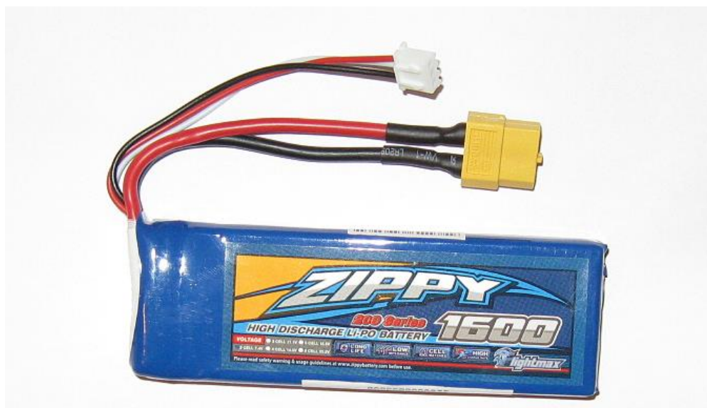
Obr. č. 4: Li-Pol akumulátor [9]
