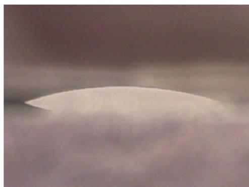
(b) Kvapka s veľmi malým kontaktným uhlom
