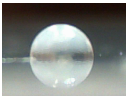
(f) Kvapka odrážajúca sa od povrchu tak, že výsledný tvar je takmer kruh
