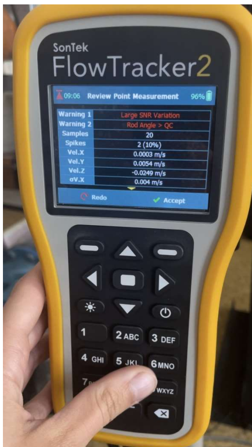
Obrázek 4.4.1 Chybová hlášení (červeně) zobrazena na vyhodnocovací jednotce
