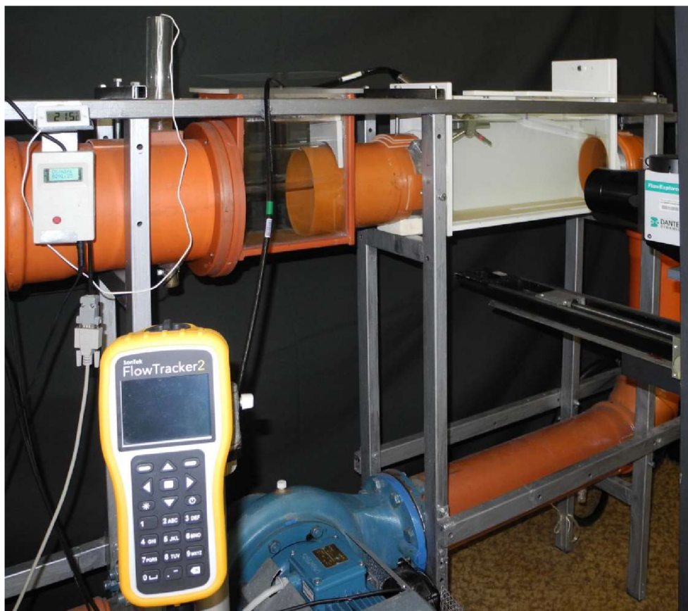
Obrázek 4.4.3 Pohled na vyhodnocovací jednotku a 2.měrný prostor zkušební trati
