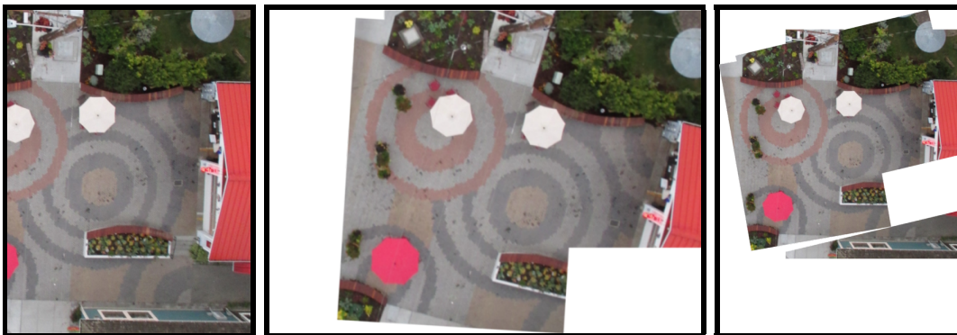
Obrázek 4.1: Vlevo je podkladový obraz, který je spojován s prostředním obrazem. Výsledek funkce warpPerspective() je znázorněn na pravém obrazu. Obraz je ohraničen černým rámem, bílá barva je ve skutečnosti průhledná. Průhledný pravý dolní roh prostředního obrazu překreslí podkladový obraz. Převzato z [8] a upraveno programem.
