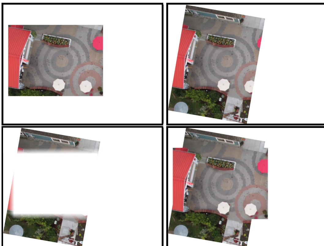
Obrázek 4.4: Nahoře jsou zobrazeny dva spojované obrazy – vlevo podklad, vpravo přidávaný. Levý obraz dole je výstup vyhlazení přechodu s hloubkou prolínání 30 pixelů. Vpravo dole je už výsledný obraz – spojený podklad a obraz s vyhlazeným přechodem. Obraz je ohraničen černým rámem, bílá barva je ve skutečnosti průhledná. Převzato z [8] a upraveno programem.
