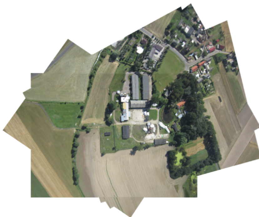
Obrázek 5.4: Výsledek spojování kolekce Boruszyn na zařízení Nexus 5 v rozlišení 4000 \times 3000 . Doba spojování: 2h 32min. Převzato z [8] a upraveno programem.
