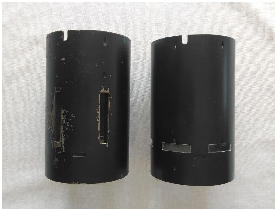
Obrázek 3.2 Původní a nové rozmístění nasávacích otvorů
