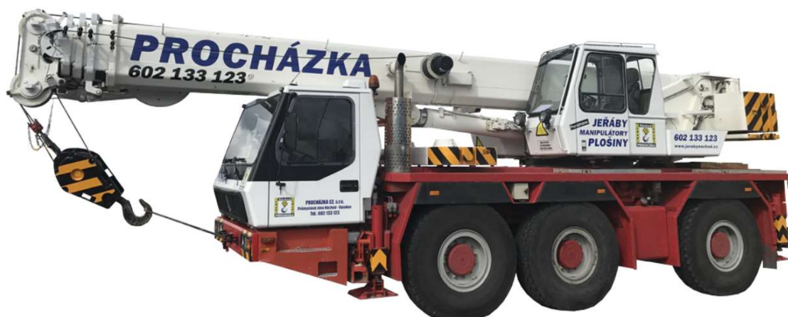
Obr. 57 – autojeřáb pro montáž věžového jeřábu [22]
