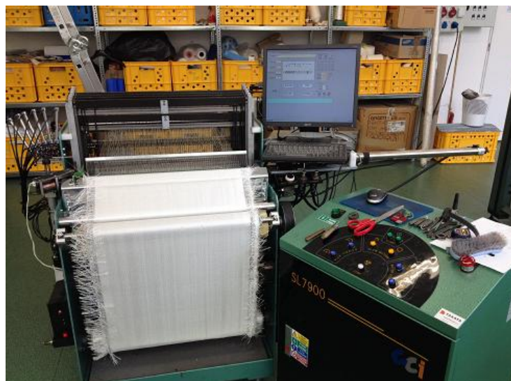
Obr. 7 - laboratorní jehlový tkací stroj
