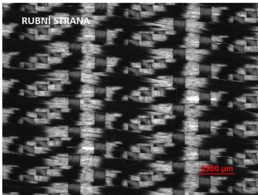
11. dvojútková tkanina v keprové vazbě K 1/5 (Z) - útek: sklo/sklo (1:1) D_{\text{ú}} = 2 \times 30 / \text{cm}
