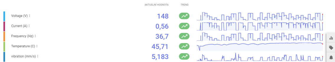
Obr. 5.2: Souhrn naměřených dat z elektromotoru zobrazených na stavové obrazovce
