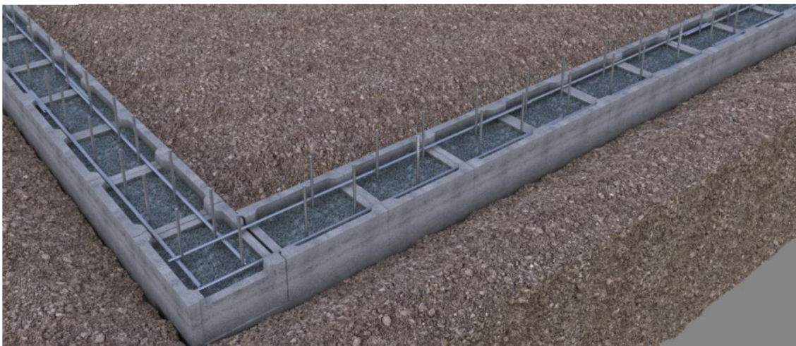
Obr. č. 38 DEK Základové pásy [25]
