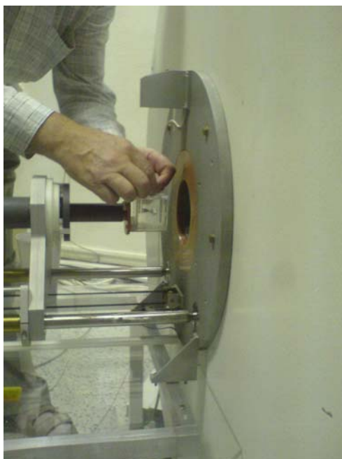
Obr. 11 Umístění měřícího přípravku do tomografu
