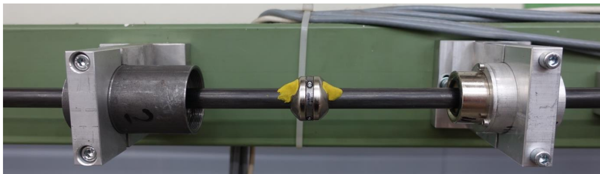
Obrázek 20: Magnetický akumulátor kinetické energie s plastelinovou hmotou pro kontrolu vzdálenosti pohyblivých magnetů od magnetů rámu v úvratích rozváděcího pohybu
