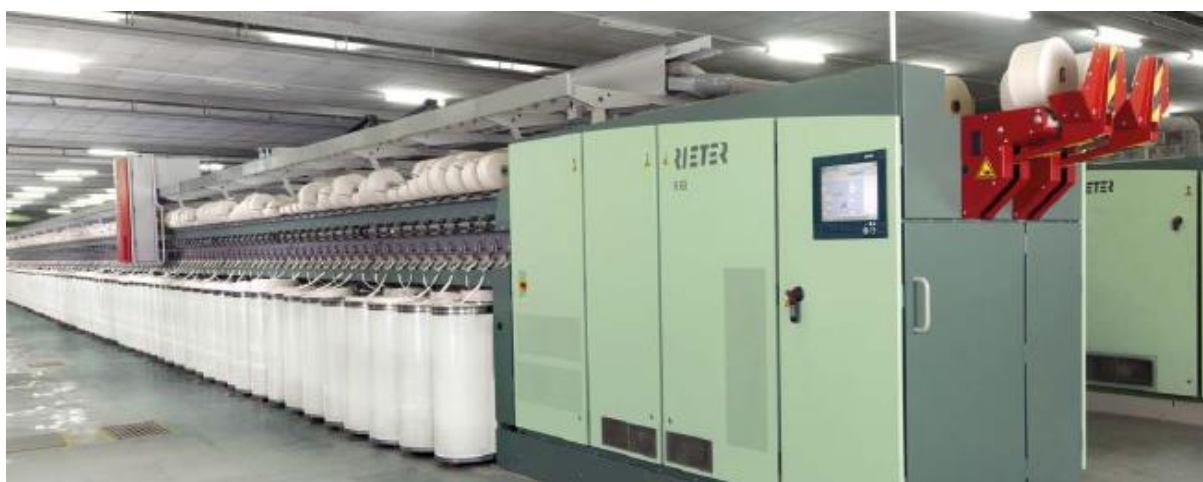
Obrázek 1: Rotorový dopřádací stroj Rieter R60 [7]
