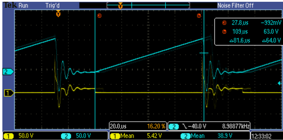
Obrázek 8.8 Průběh na aktuátoru (modrá), vstupní řídicí signál na gate tranzistoru Q1 (žlutá), výsledný průběh dle požadavků
