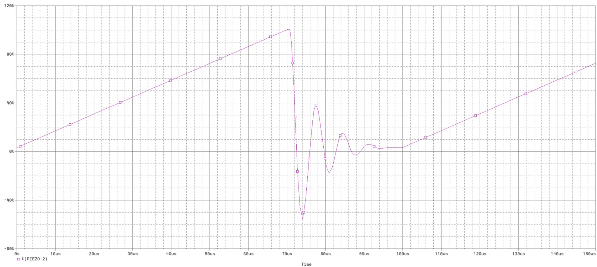
Obrázek 6.4 Průběh napětí na piezoaktuátoru
