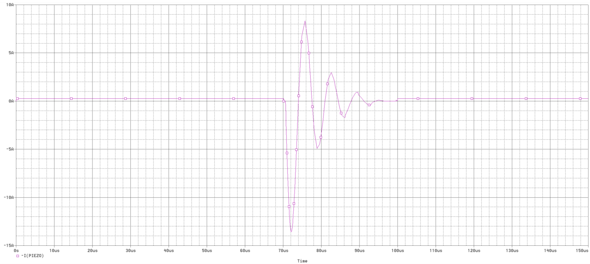
Obrázek 6.5 Průběh proudu na piezoaktuátoru
