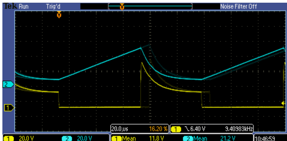
Obrázek 8.7 Průběh na aktuátoru (modrá), vstupní řídicí signál na gate tranzistoru Q1 (žlutá), OZ není v saturaci, nefunkční rezonanční obvod
