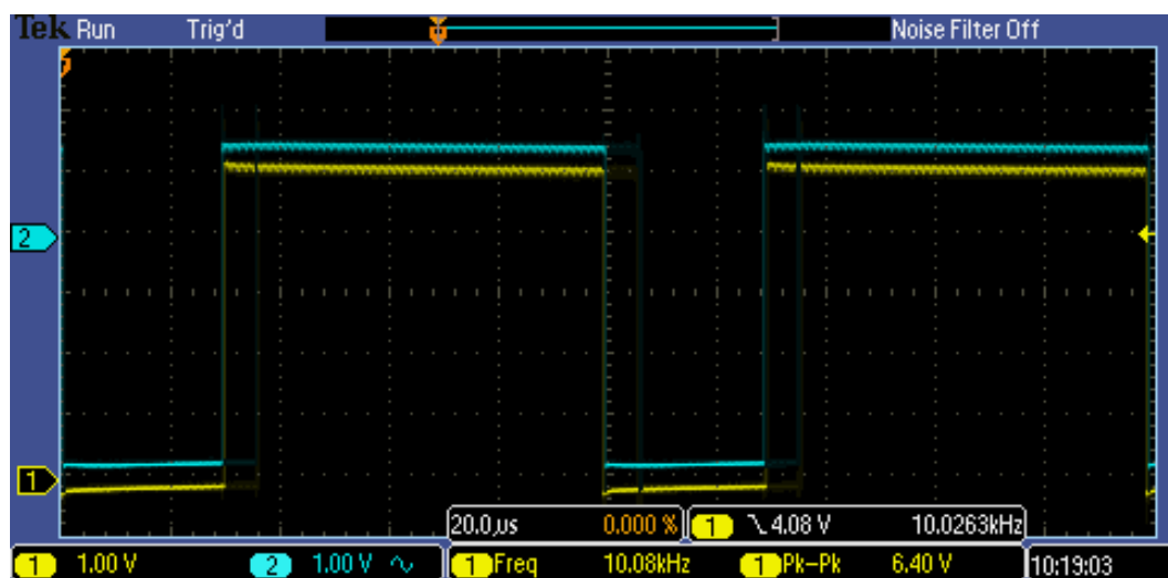
Obrázek 7.21 Generovaný signál pro spínače pomocí Arduino Uno
