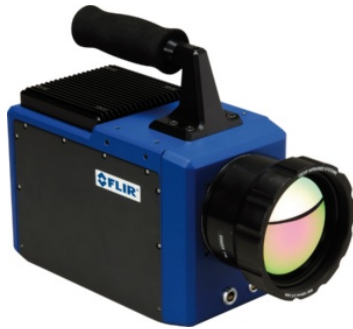
Obrázek 4-1 – Termokamera FLIR SC 7550 320x256 px, 380 Hz, výřez až 28,8 kHz InSb chlazení senzor 1,5 – 5,1 \mu\text{m} GigE, Pal, 253x130x168 mm
