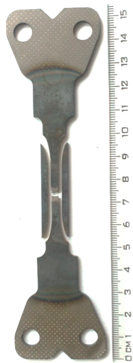
Obrázek 5–16 – Rozříznutý vzorek pro další analýzy (již po zkoušce tahem)
