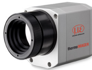
Obrázek 4-2 – Termokamera Micro Epsilon TIM 400 382x288 px, max. 60 Hz, 7,5 – 13 \mu\text{m} USB2, 46x56x90 mm
