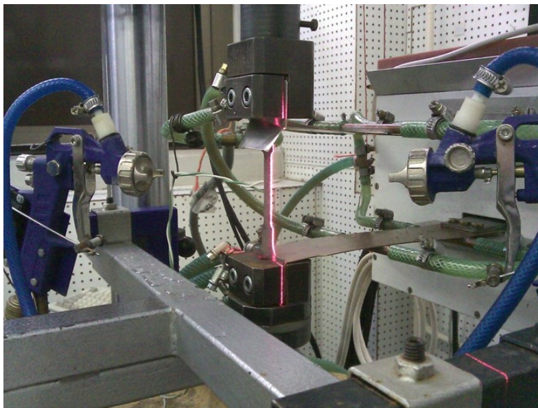
Obrázek 5–18 – Původní chlazení se stříkacími pistolemi ovládanými servy
