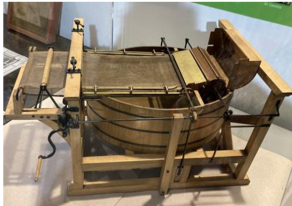
Obrázek 5: Papírenský stroj Fourdrinierové konstrukce
