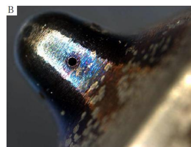
Obr. 25: Poškození trysky způsobené příliš vysokou teplotou [11] a) po vyjmutí vstřikovače b) po očištění - charakteristické zbarvení materiálu
