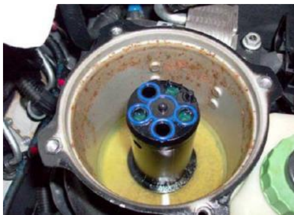
Obr. 22: Nečistoty zachycené palivovým filtrem [11]
