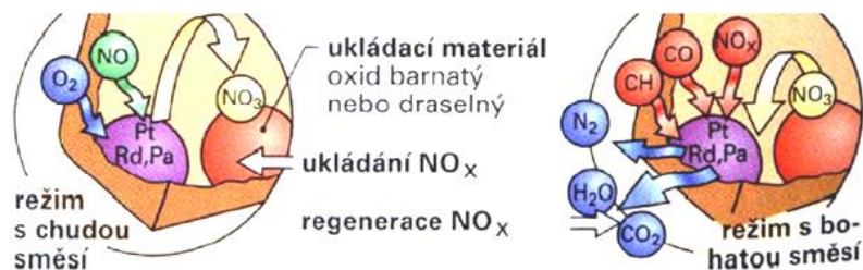
Obr. 11: Ukládání a regenerace v zásobníkovém NO x katalyzátoru [16]
