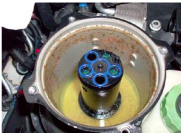
Obr. 22: Nečistoty zachycené palivovým filtrem [11]
