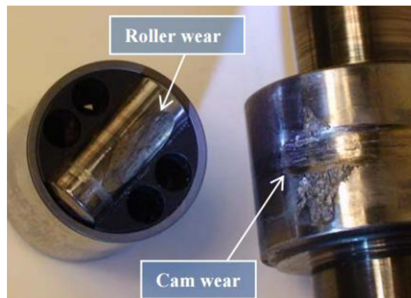
Obr. 23: Poškození místa kontaktu váčky a pístu čerpadla [11]
