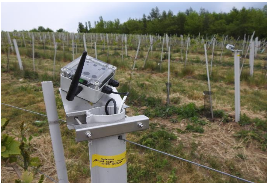
Obrázek 3: Autonomní telemetrická sonda Agronode na vinici, autor: Mikuláš Čapla
