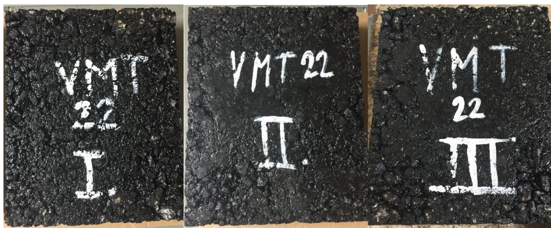
Obrázek 29: Zhutněné zkušební desky ze směsi A
