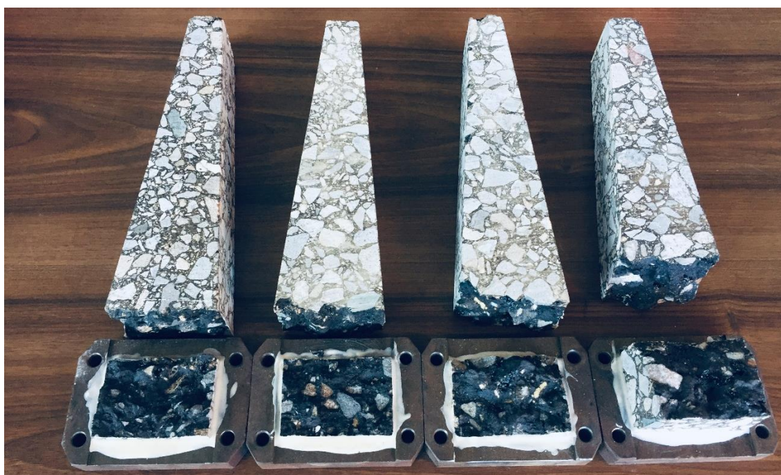
Obrázek 40: Tělesa ze směsi B po zkoušce odolnosti vůči únavě
