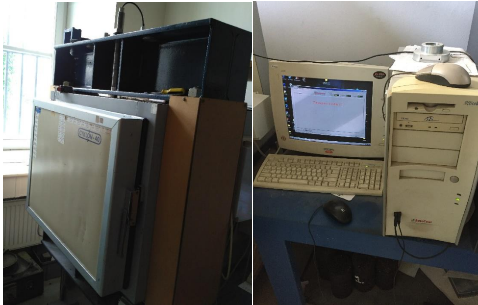
Obrázek 34: Zkušební přístroj CYKLON 40 s řídicím počítačem
