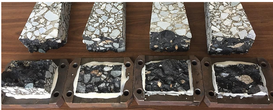
Obrázek 39: Tělesa ze směsi A po zkoušce odolnosti vůči únavě
