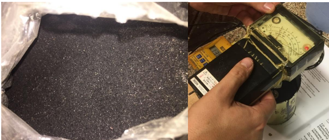
Obrázek 50: Pryžový granulát a ověření viskozity asfaltového pojiva
