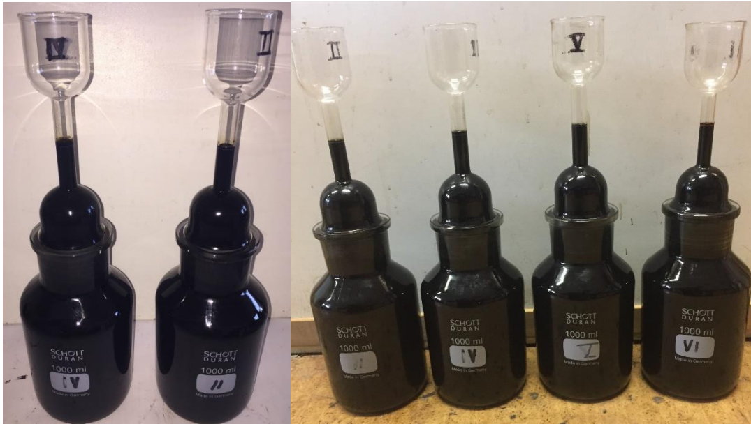
Obrázek 27: Pycnometry s asfaltovou směsí a rozpouštědlem
