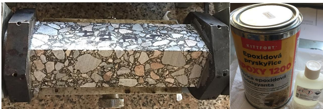
Obrázek 32: Přilepené zkušební těleso v ocelové formě (vlevo)
