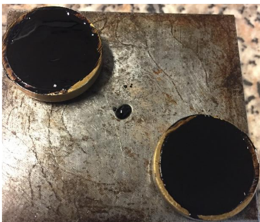
Obrázek 18: Silniční asfalt gradace 20/30 před stanovením bodu měknutí
