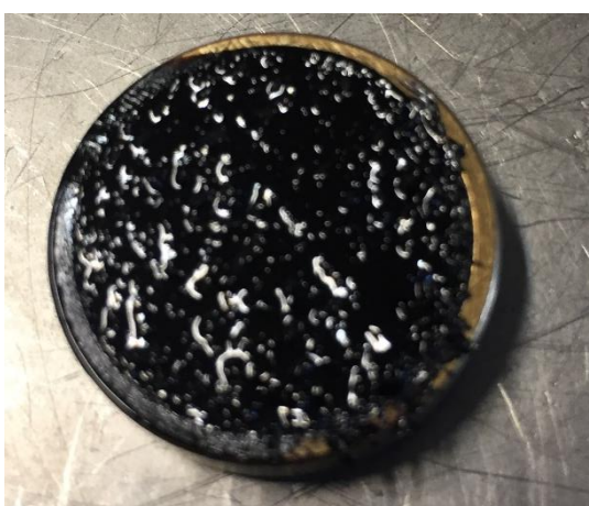
Obrázek 19: Asfaltové pojivo CRMB před stanovením bodu měknutí
