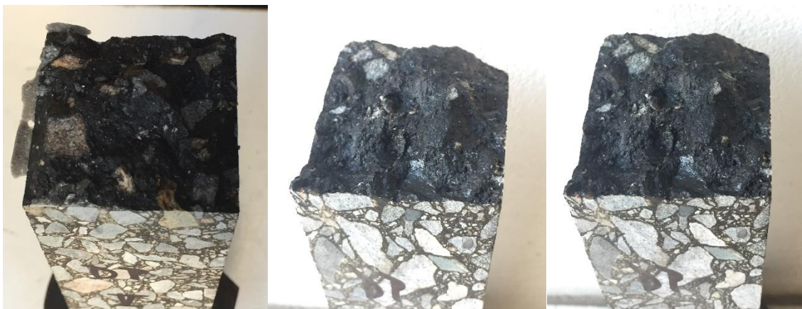
Obrázek 35: Zkušební tělesa porušené mrazovou trhlinou
