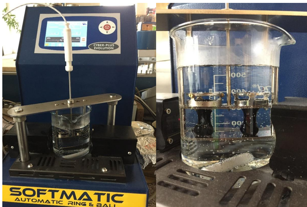
Obrázek 20: Přístroj na stanovení bodu měknutí a protažené pojivo po zkoušce
