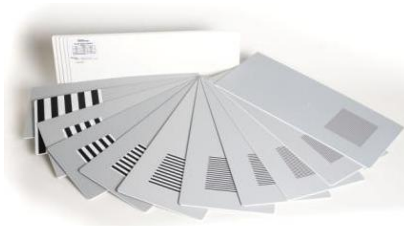
Obr. 4 – Teller Acuity Cards. První karta bez vzoru je tzv. Blank Card, další s proužkováním po celé šířce je Low Vision Card, dále následují karty se snižujícím se mřížkováním (Teller Acuity Cards Half Set of 8 cards, online).
