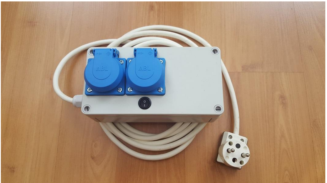
Obrázek B.8 Mnou vyrobená vzdáleně ovládaná zásuvka
