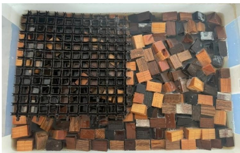
Obrázek 23: Nabobtnalá tělesa ponořená v destilované vodě (autor)
