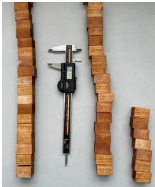
Obrázek 22: Digitální posuvné měřítko ICONIC Labo 150 mm (autor)
