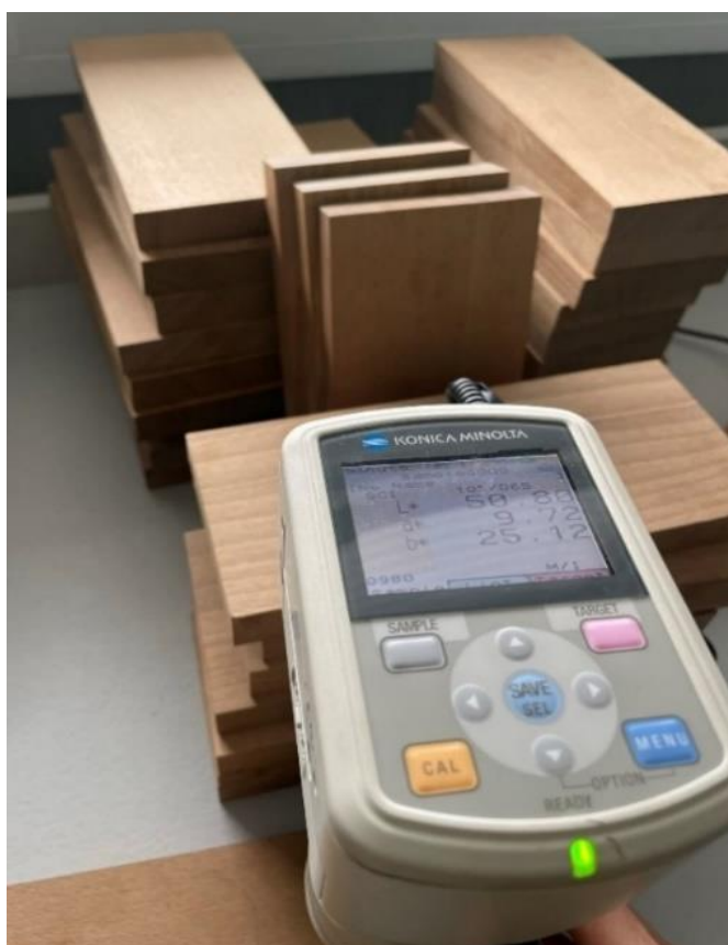
Obrázek 25: Digitální přenosný spektrofotometr CM-700D (autor)
