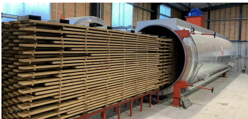
Obrázek 3: Autokláv používaný k termické modifikaci (Brimstone, 2024)
