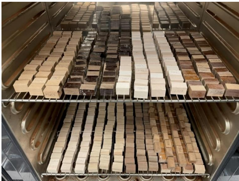
Obrázek 21: Sušení těles pro absolutně suchý stav (autor)
