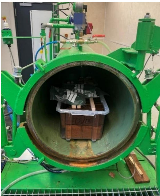
Obrázek 19: Zatížená tělesa v tlakové impregnační komoře (autor)
