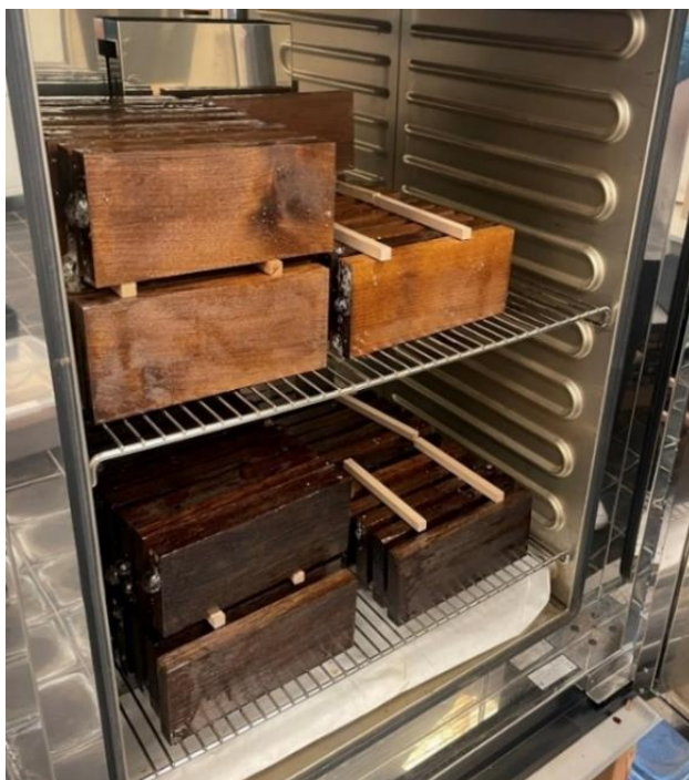
Obrázek 20: Impregnovaná tělesa v sušárně s proklady (autor)
