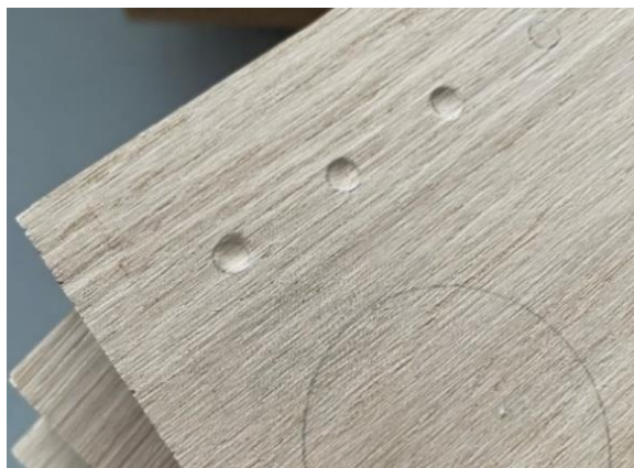
Obrázek 27: Zkušební těleso po měření tvrdosti (autor)
