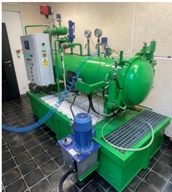
Obrázek 18: Tlaková impregnační komora VTIZ 0,5 x 2 (autor)
