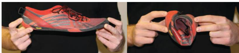
Obrázek 3. Testování podélné flexibility obuvi (výchozí testovací pozice vlevo, konečná testovací pozice vpravo) (Esculier et al. 2015)
