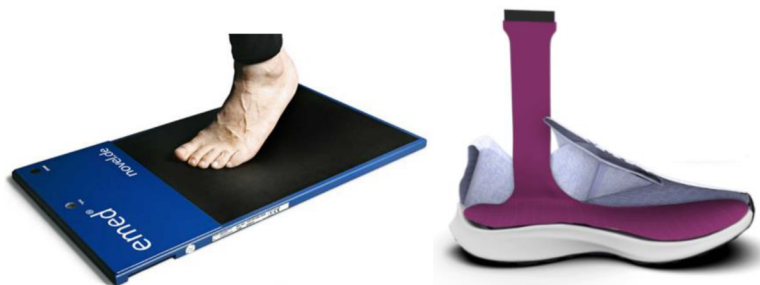
Obrázek 9. Tlaková plošina Emed® (vlevo) a senzorická vložka Pedar® (vpravo) ( https://www.novel.de )
