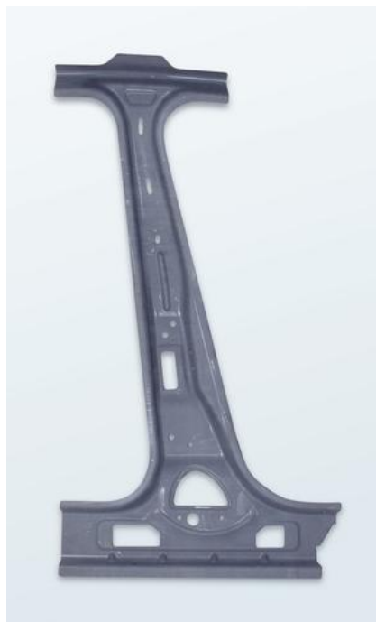
Obr. 8 B sloupek (tloušťka: 1,85 mm) z martenzitické ocele [26]
