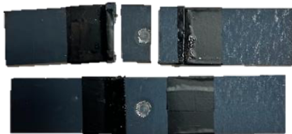
Obr. 32 Řez svařence pro metalografický výbrus a strukturní analýzu
