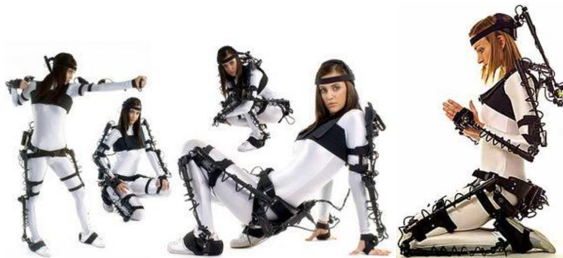
Obrázky 14,15 Obleky na mechanické snímání pohybu Gypsy6. [22] [23] (zdroj: reemotionfiles.blogspot.com , Metamotion.com )
