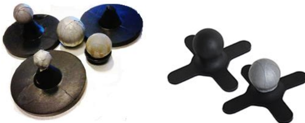
Obrázek 9,10 Značky pro optické snímání pohybu. [15] [16] (zdroj: Flickr.com , Mocapsolutions.com )
