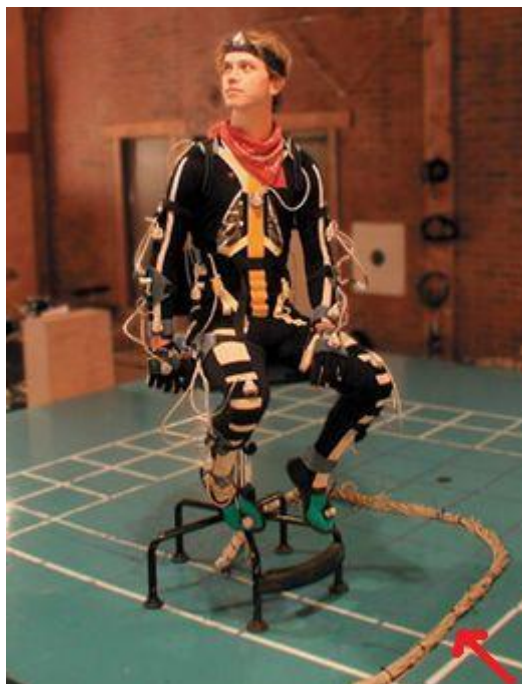
Obrázek 7: Oblek na magnetické Motion Capture, u tohoto obrázku si můžeme všimnout svazku kabelů, na které je herec připojen. [12] (zdroj: Limevoodoo.com)
