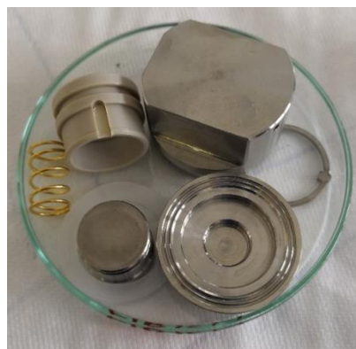
Obr. 27: Rozobratá elektrochemická cela
