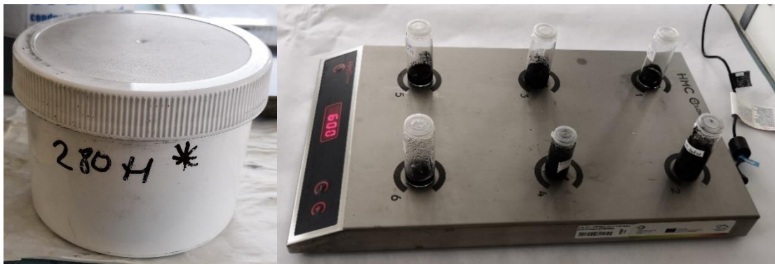
Obr. 20: Prírodný grafit 280 H a použitá miešacia stanica
