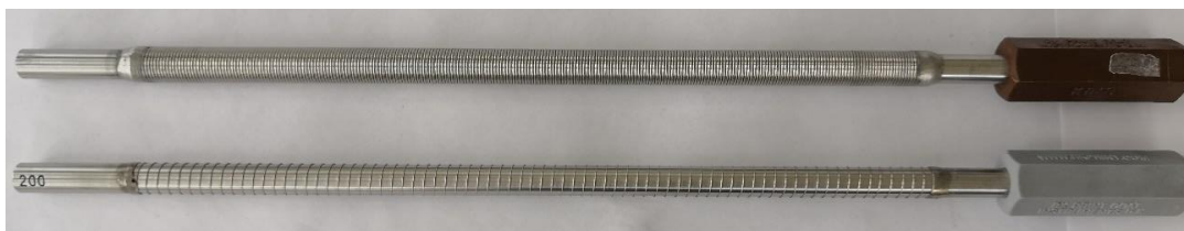
Obr. 21: Tyče na roztieranie elektródovej zmesi
