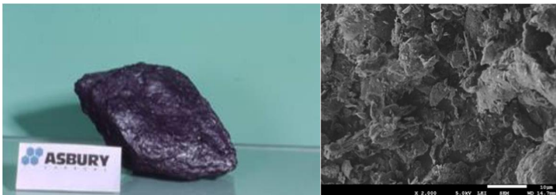
Obr. 12: Amorfny grafit (vľavo) [36], jeho zväčšená štruktúra vpravo [37]
