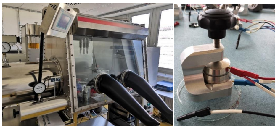
Obr. 28: Rukavicový box vľavo, zložená elektrochemická cela vpravo
