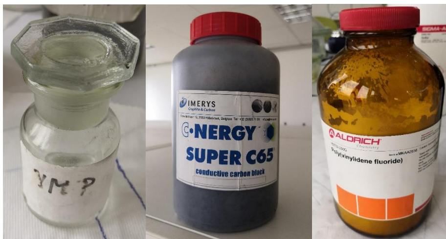
Obr. 19: Prísady v elektródovej zmesi, rozpúšťadlo NMP (vľavo), zvodivujúca zložka C65 (uprostred), spojivová zložka PVDF (vpravo)
