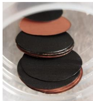
Obr. 26: Vyseknuté elektródy v detaile
