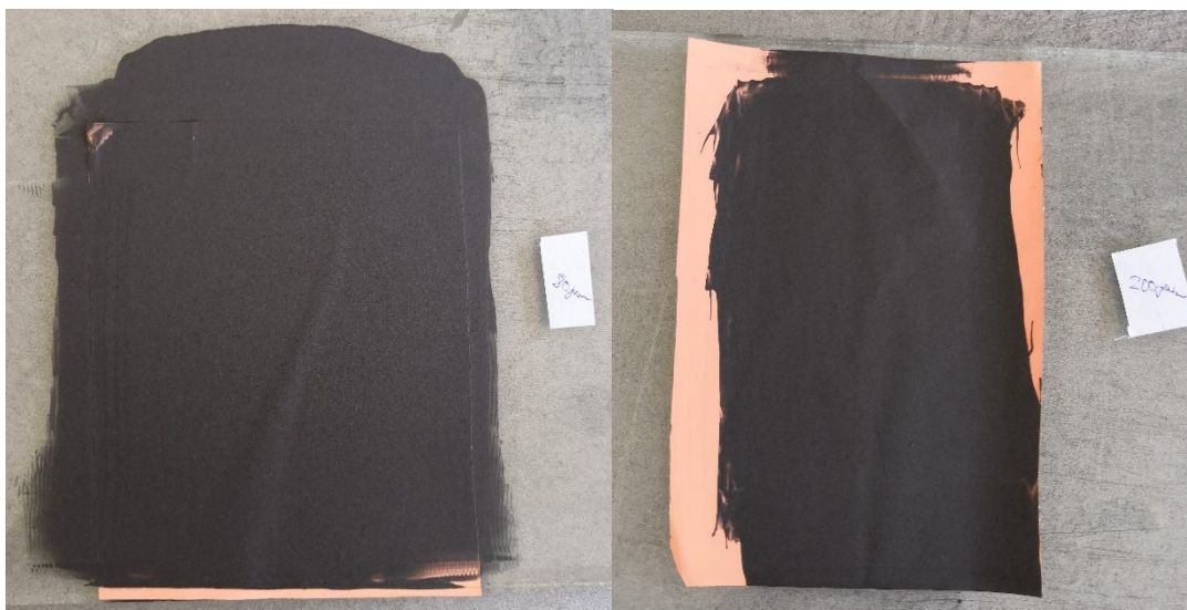
Obr. 22: Nanesená elektródová zmes na medennej fólii (80 \mu\text{m} a 200 \mu\text{m} )
