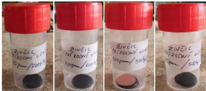
Obr. 24: 4 typy záporných elektród
