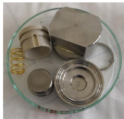
Obr. 27: Rozobratá elektrochemická cela
