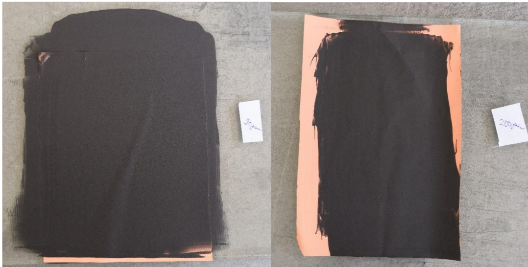
Obr. 22: Nanesená elektródová zmes na medennej fólii (80 \mu\text{m} a 200 \mu\text{m} )
