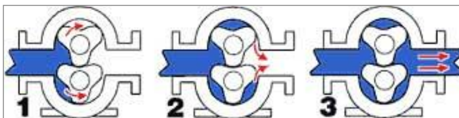
Obr. 2 Pracovní cyklus čerpadla s rotačními písty
