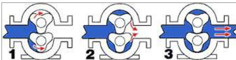
Obr. 2 Pracovní cyklus čerpadla s rotačními písty
